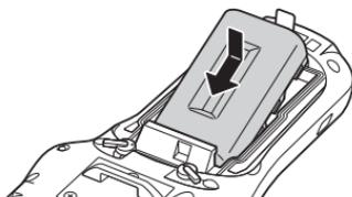
4. Setzen Sie den Akkupack-Deckel laut den Pfeilen 1 und 2 der Abbildung wieder auf das Batteriefach auf und drehen Sie die Akkupack-Deckelverriegelung in die Stellung „LOCK“.
